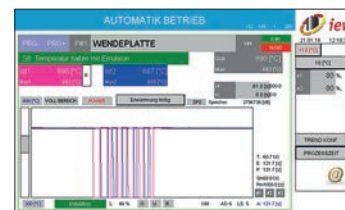
Unterbrechung eines Pyrometerstrahls in der Haltephase
