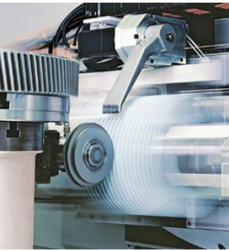
*Integrierte Profilabrichteinrichtung bringt Schleifwerkzeuge schnell und zuverlässig in Form.*
