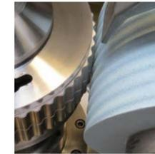
Zykloidgetriebe zeichnen sich durch hohe übertragbare Momente, hohe Steifigkeit und Verschleißarmut aus. Für die hochgenaue Profilbearbeitung der beiden Hauptkomponenten eines Zykloidgetriebes, Kurvenscheibe und Bolzenring, stehen leistungsfähige Technologien zur Verfügung.
