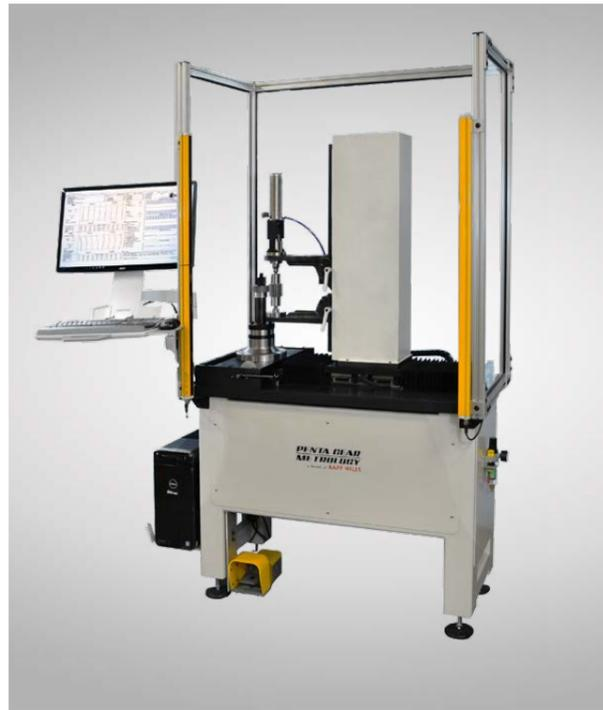
Linearantrieb zur Sicherstellung der optimalen Geschwindigkeit und des idealen Drucks während der Messung
