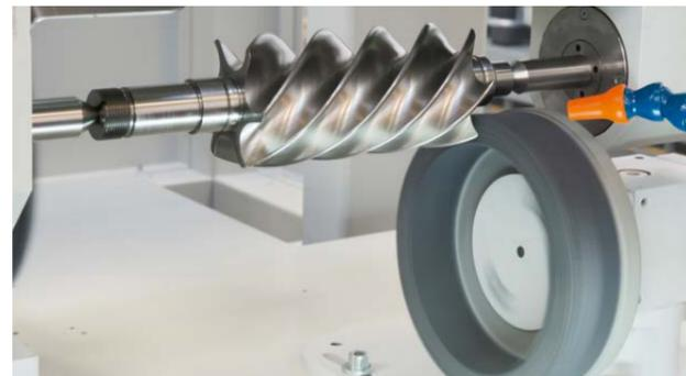
Schruppen und Schlichten in einer Aufspannung
