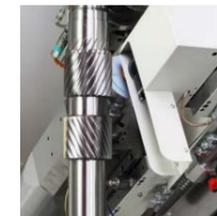
KAPP NILES bietet eine breite Palette an Maschinenkonzepten zum Schleifen von Pfeilverzahnungen in den unterschiedlichsten Größenbereichen an. Ob mit horizontaler oder vertikaler Werkstückachse ausgeführt, kann bei allen Maschinen die Hard- / Software mit innovativen Lösungen zum Schleifen von Pfeilverzahnungen ausgerüstet werden.
