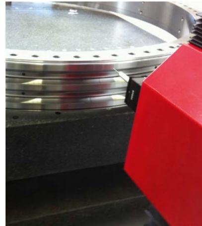
X- und Z-Achse aus Granit mit Luftlagerung,
