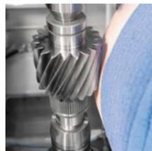
KAPP NILES Maschinen bieten die Möglichkeit, die Technologien Feinschleifen und Polierschleifen sowohl beim Profil- als auch beim Wälzschleifverfahren zu nutzen. Der zusätzlich erforderliche Zeitaufwand beträgt im Regelfall weniger als 50 % der konventionellen Schleifbearbeitung.
