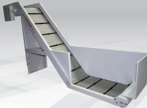
Der Transport des Fördergutes erfolgt auf einem Endlosscharnierband. Das Fördergut wird auf der Oberseite des umlaufenden Scharnierbandes transportiert. Mitnehmer sorgen für einen Weitertransport im Steigteil. Die Kühlschmierstoffe werden im Fördergehäuse gesammelt und über einen **optional lieferbaren Kühlmittelbehälter** oder eine Pumpstation dem Maschinenkreislauf wieder zugeführt.
