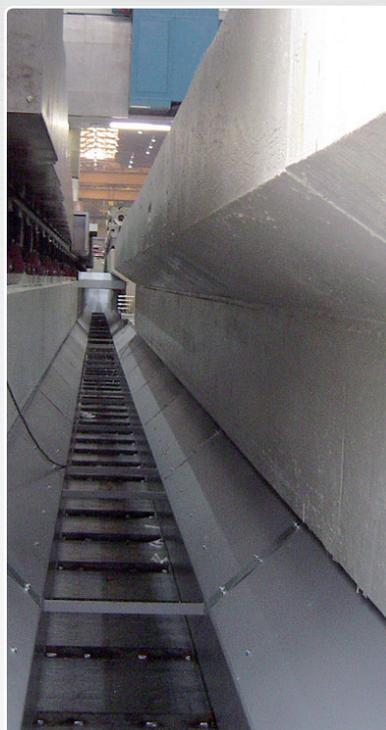
Der Scharnierbandförderer ist geeignet für **lange Stahl- und Wollspäne** in der Trocken- und Nassbearbeitung. Je nach Bedarf kann er aus verschleißfesten Materialien oder Kunststoff gefertigt werden. Ausführungen als Einzelförderer oder als verkettete Einrichtung sind verfügbar, außerdem können die Anlagen entsprechend der Anwendungsfälle für den Innen- oder Außenbereich konzipiert werden.
