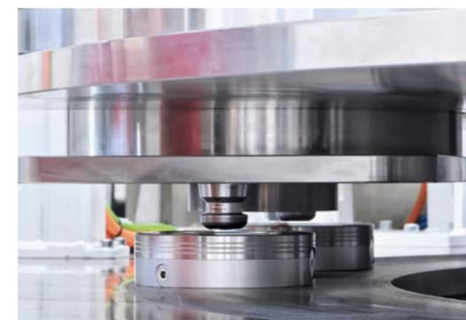
**Nullspannsystem für hochpräzises Positionieren zum prozesssicheren Fügen von Komponenten.**
