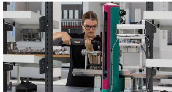
**Drehwinkel- und Drehmomentüberwacher Handschrauber mit integriertem WLAN zur Übertragung der Ergebnisse an den Kundenserver.**
