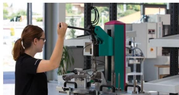
**Kraft- und wegüberwachte Kniehebelpresse zum Einpressen von Komponenten.**
