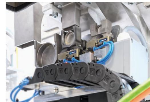
**Zuführeinheit Verschlussstopfen die zusätzlich während des Pressvorgangs verklebt werden.**
