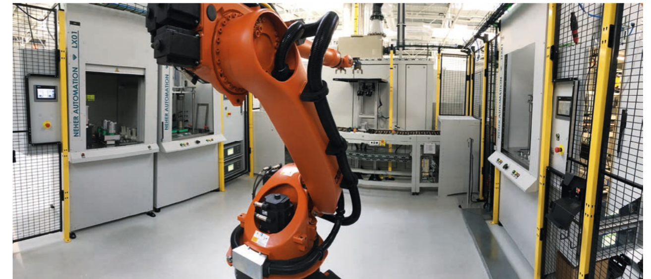
KUKA-Zelle mit integrierter Reinigungsanlage, Bauteilerkennung, Dichtheitsprüfung DX01 und Laseranlage LX01
