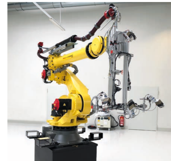
FANUC Roboter mit einem Greifersystem für großvolumige Strukturbauteile
