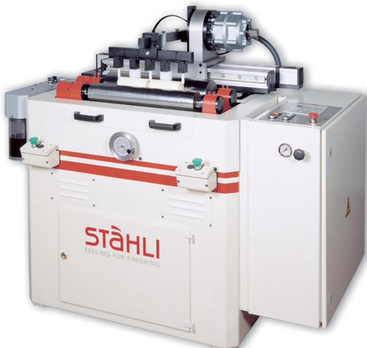
Die Rundläpp- und Poliermaschinen der CLM-Baureihe eignen sich besonders für das zeitsparende, spitzenlose Rundläppen und Polieren längerer Werkstücke zwischen 2 parallel laufenden Walzen.
