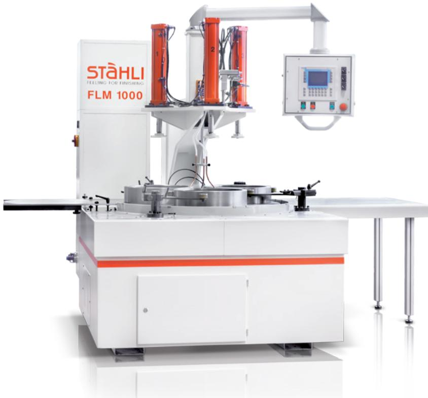
Die einseitige Flachläpp- und Poliermaschinen der FLM Baureihe, mit Scheibendurchmessern von 500 bis 4000 mm, sind für den Produktionseinsatz perfekt optimiert.
