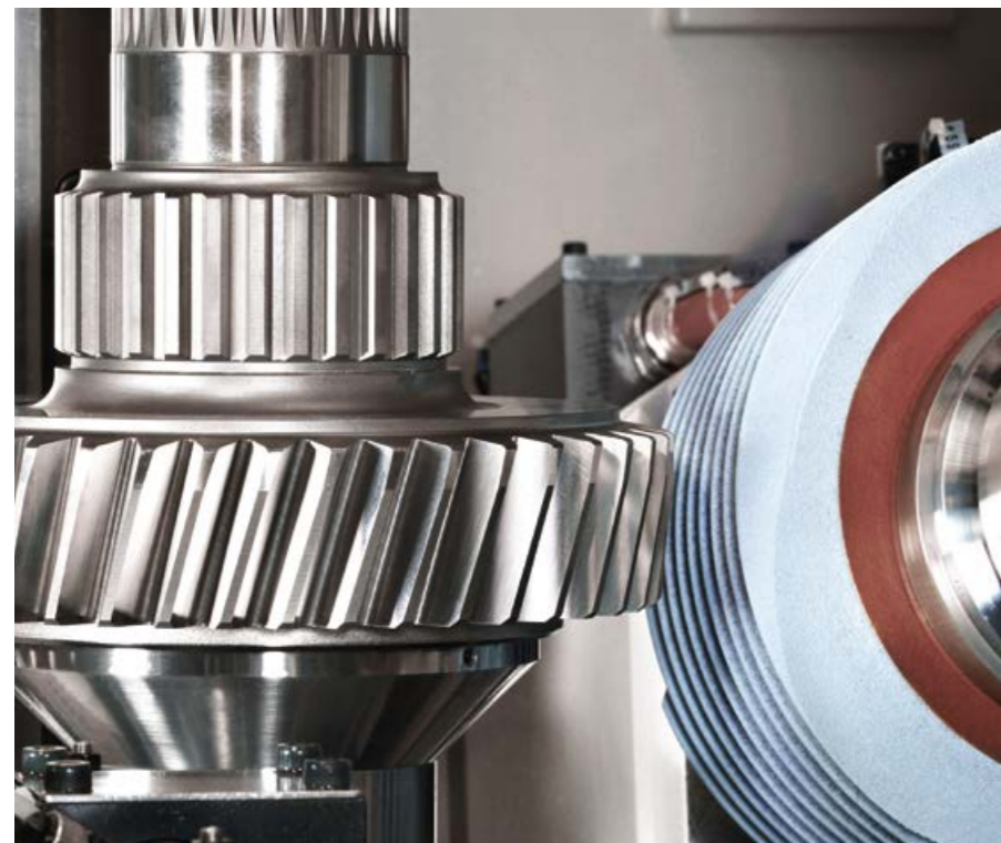
Werkzeug- und Werkstückspindel mit Direktantrieb
