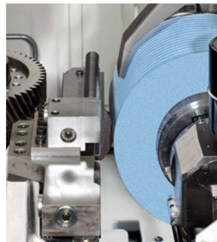
Werkzeug- und Werkstückspindel mit Direktantrieb
