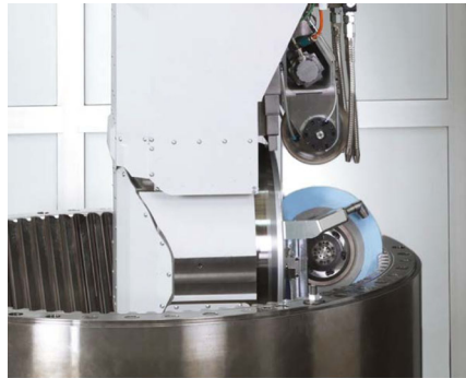
ZP I/E mit schnell wendbarem Schleifarm für die Bearbeitung großmoduliger Innen- und Außenverzahnungen
