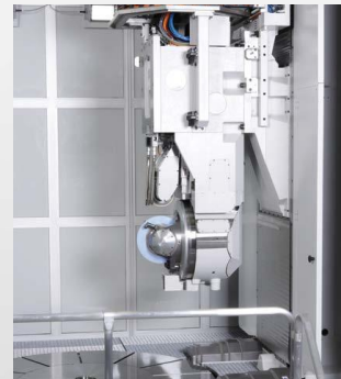
ZP I/E mit schnell wendbarem Schleifarm für die Bearbeitung großmoduliger Innen- und Außenverzahnungen
