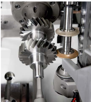
Außen-, Innen-, Gerad- und Schrägverzahnungen sowie Sonderprofile
