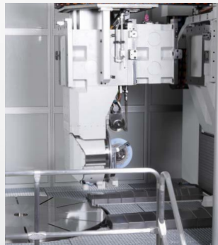
ZP I/E mit schnell wendbarem Schleifarm für die Bearbeitung großmoduliger Innen- und Außenverzahnungen
