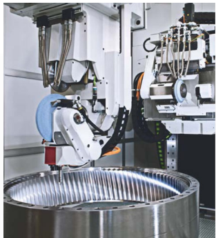
ZP E/I mit rüstoffreiem Wechsel zwischen Außen- und Innenbearbeitung
