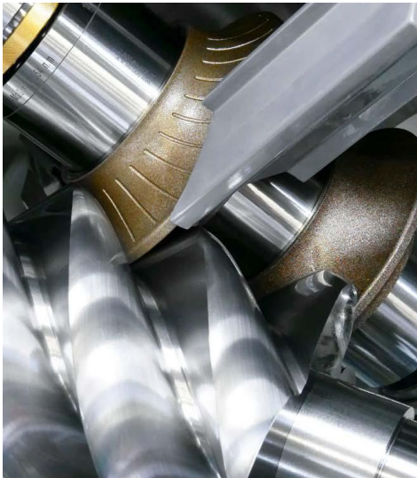
Schruppen und Schlichten in einer Aufspannung
