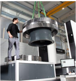
Oben: Messen eines Rotors Unten: Beladung der Messmaschine KNM 50X
