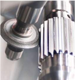
Oben: Abrichten einer Korundschleifscheibe Unten: Profilschleifen einer Turbinenwelle
