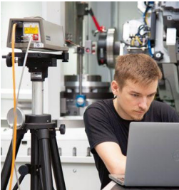
Oben: Montieren einer Baugruppe Unten: Vermessung von Maschinen- achsen mit Lasermessgerät
